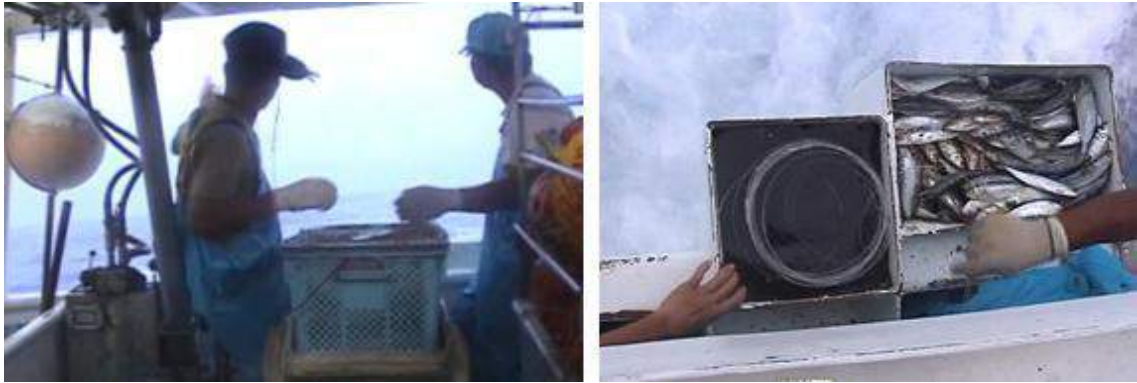
宏徳丸の投縄光景 1 左：船尾から2人で、左人後方見えるのが投縄機。船をゆっくり航行しながら投縄。右：上から見た縄置台とエサ置台。投縄は1200本の釣針にエサのムロアジ掛け、枝縄、幹縄入れの作業。
